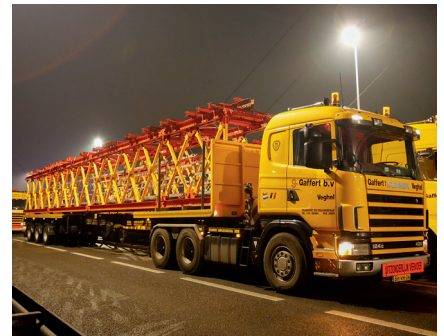
Nopea asennus työmaalla Ristikoita on mahdollista toimittaa valmiiksi esikäsittöinä yksiköinä, mikä nopeuttaa työmaan asennusta entisestään.
