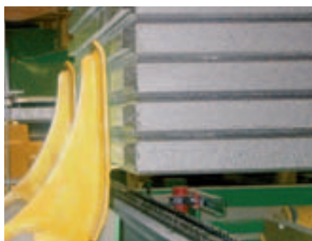
Esimerkki CNC-sahatusta levystä REKERS-niputtajassa.
