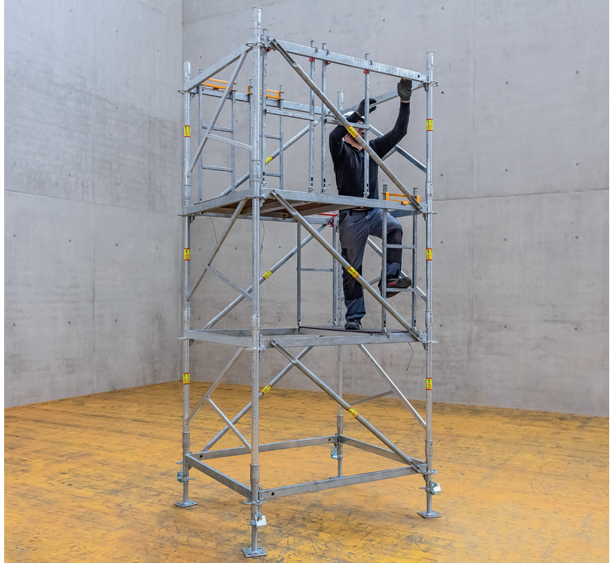
Järjestelmään on integroitu korkea turvallisuustaso. Käyttäjä kiipeää käyttämällä tornin sisällä olevia tasoja asennuksen aikana. Tällä tavoin käyttäjä on aina turvattu reunakaiteen avulla.
