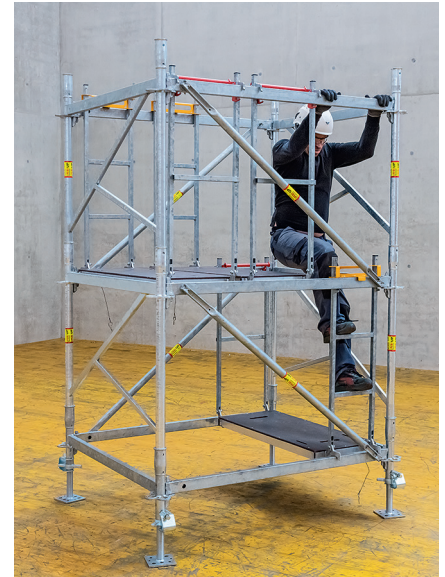
Tason välisuojakaidetta voidaan käyttää myös kiipeilyapuna. Etäisyys on 50 cm "punaisella" puolella ja 33 cm "keltaisella" puolella.
