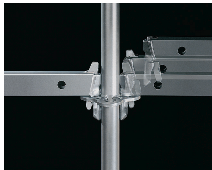
Juoksuja asennettaessa kiila putoaa rosetin aukkoon oman painovoimansa kautta ja lukittuu automaattisesti. Rosetin liitäntä on erittäin jäykkä ja siinä on korkea kuormituskyky.
